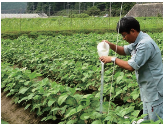
簡易土壌水分計は塩ビ管に水をいっぱいまで入れて、栓をして使う。その後、水位の下がり具合で圃場の乾燥程度がわかる
